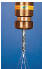
Pinza a tenuta stagna JET Per utensili con gambo cilindrico e con fori di refrigerazione interna
